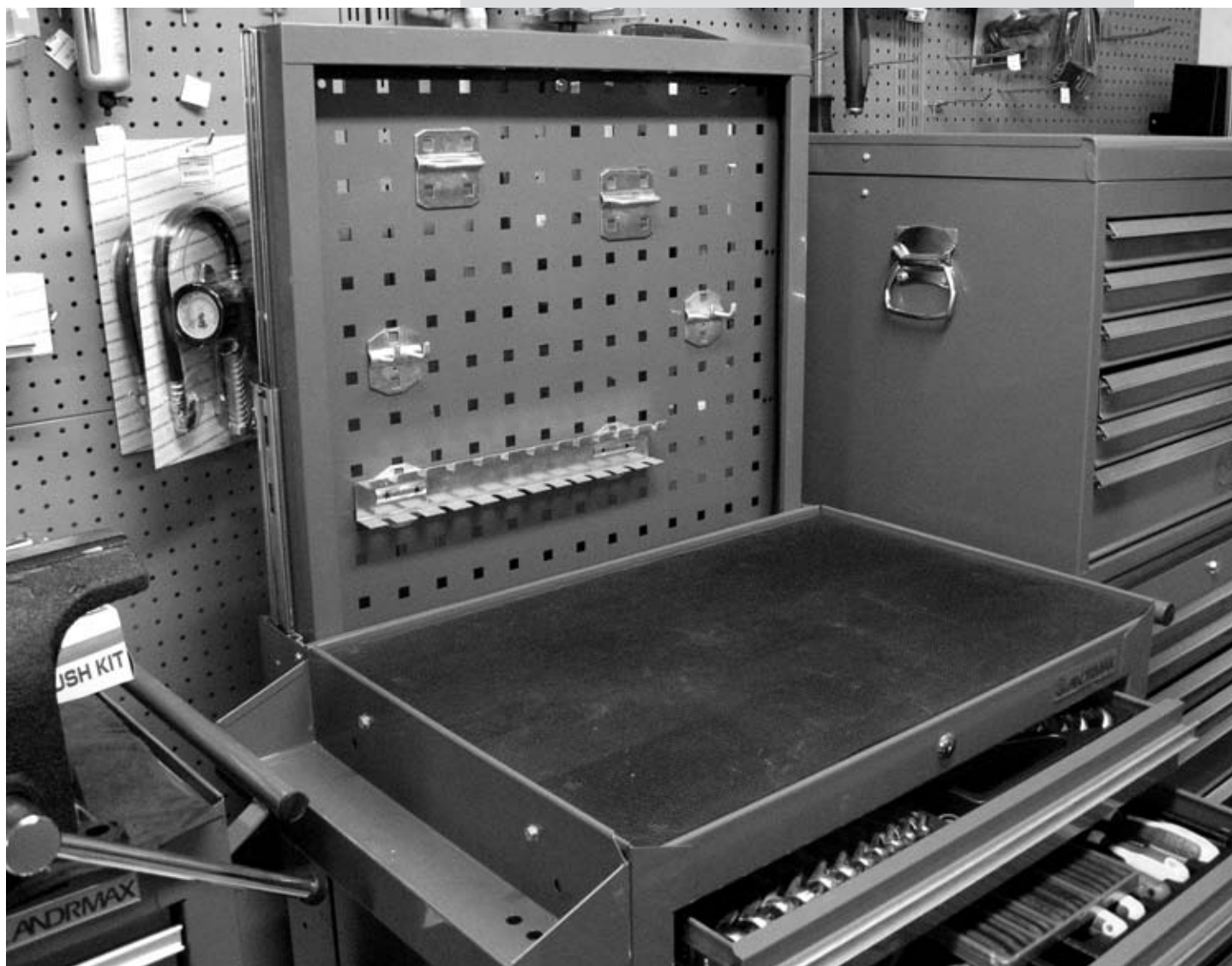
Инструментальная тележка может быть дополнена вертикальной панелью.
