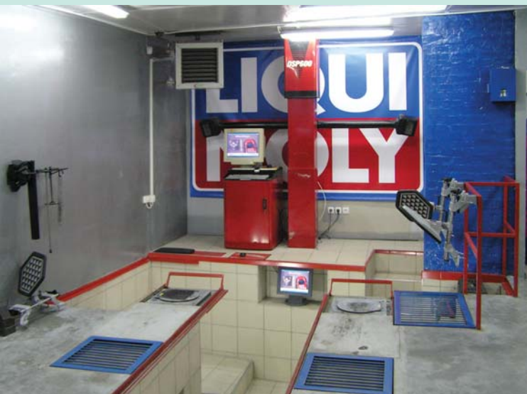
Стенд развала-схождения HUNTER DPS 600: четверть часа – и довольный клиент покидает бокс.
