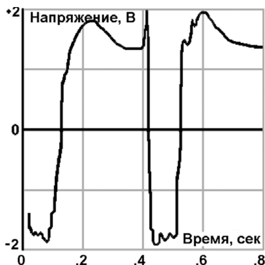
Рис. 8. Результаты проверки состава смеси на кратковременное обогащение.
