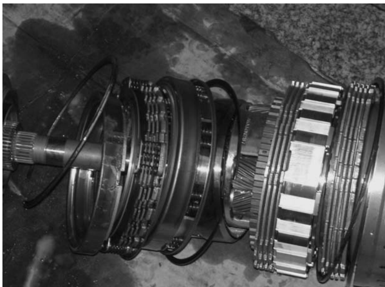
К такому печальному финалу агрегаты автомобиля приводит оставшаяся внутри влага.
