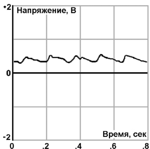
Рис. 7. Результаты проверки смеси «на обогащение».
