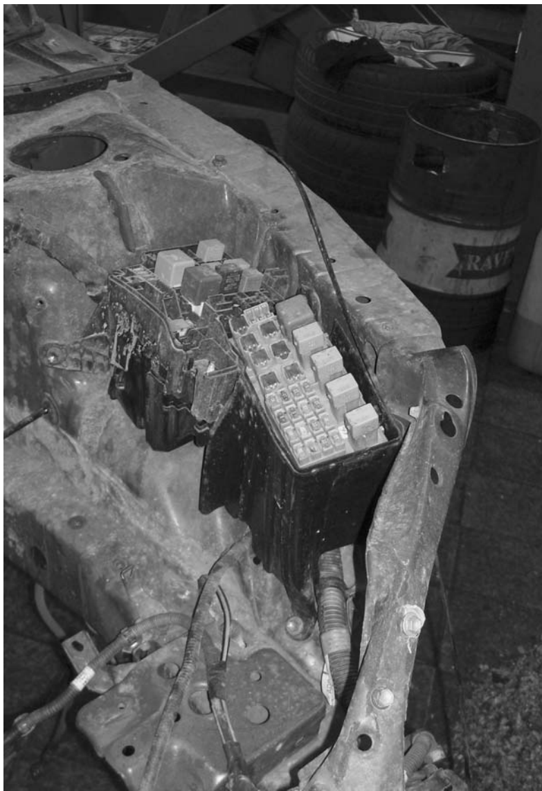
К такому печальному финалу агрегаты автомобиля приводит оставшаяся внутри влага.
