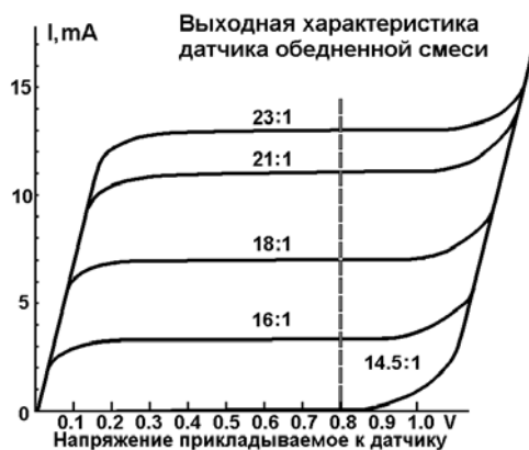
Рис. 4. Выходная характеристика датчика обедненной смеси при разном составе смеси.
