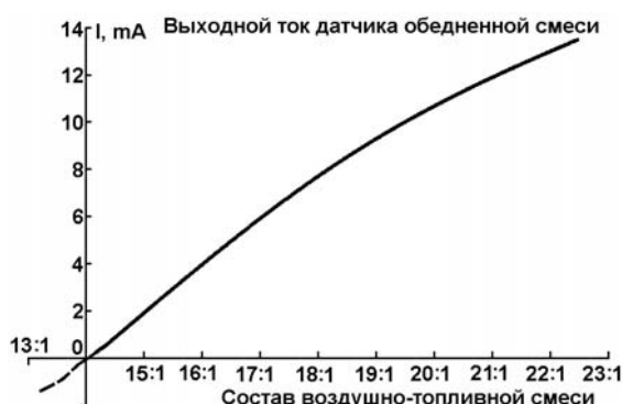
Рис. 2. Зависимость тока датчика от обеднения смеси.
