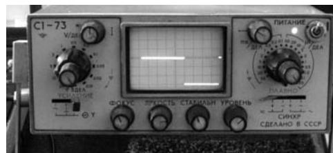
Фото 1. Проверка напряжения на подогревателе датчика с помощью осциллоскопа.
