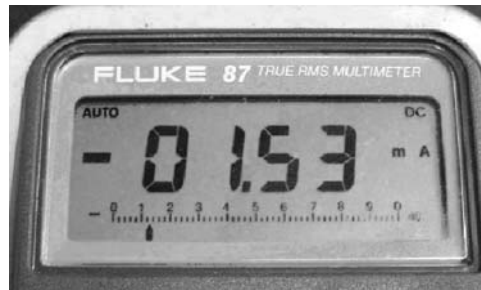
Фото 3. Ток датчика при обогащенной смеси.
