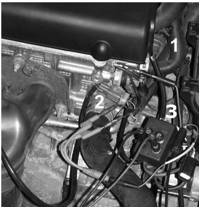
Фото 4. Подключение переходника при проверке датчика.
