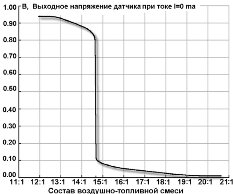
Рис. 2. Зависимость напряжения датчика от состава смеси.
