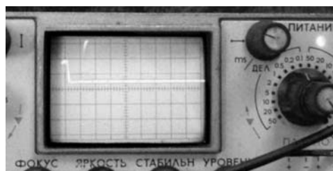
Фото 9. Напряжение на датчике после перегазовки.
