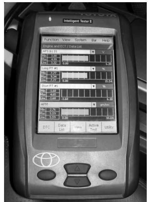
Фото 7. Проверка датчика OEM-сканером.
