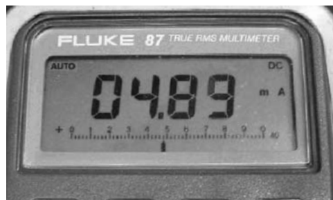
Фото 2. Ток датчика при обедненной смеси.
