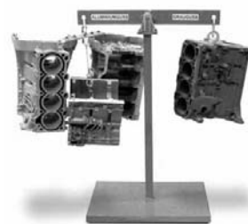
Слева - алюминиевые блоки цилиндров, справа - чугунный.
