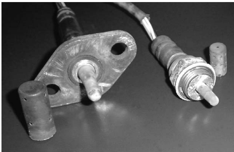
Фото 2. Способы крепления и внешний вид чувствительного элемента датчиков первого поколения.
