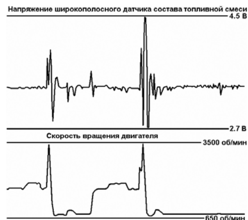
Рис. 6. График изменения напряжения при XX и при повышенных оборотах.
