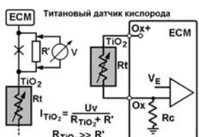
Рис. 8. Проверка сопротивления титанового датчика кислорода.
