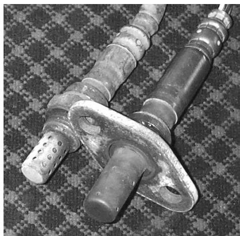
Фото 2. Способы крепления кислородных датчиков.
