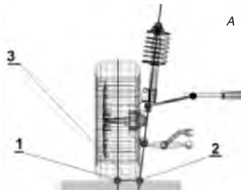
Рис. 6. Плечо обката А. Положительное Б. Отрицательное
