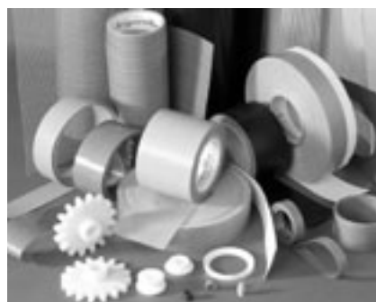
Фторопласт – замечательный полимер, из которого можно изготовить множество деталей с уникальными свойствами. Однако для работы в двигателе внутреннего сгорания гражданского автомобиля он не предназначен.
