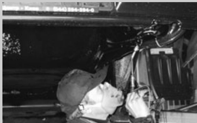
Мастер DINITROL-ЦЕНТРА наносит препарат на битумно-восковой основе.
