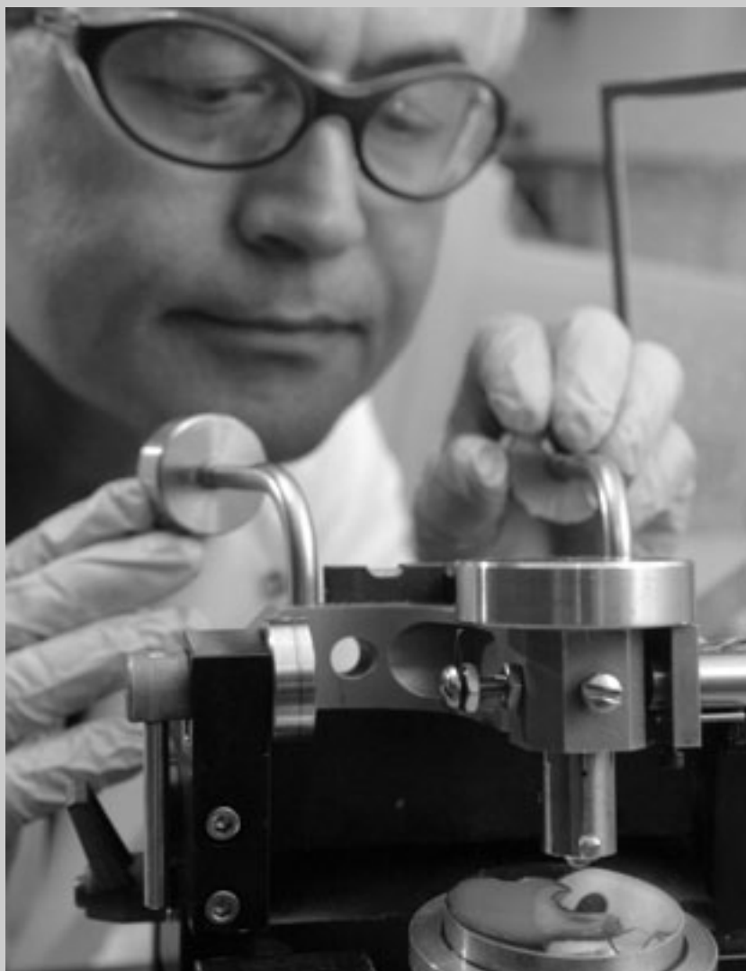
Али Эрдемир, ученый из Национальной лаборатории имени Аргонна (США), проводит тест по замеру трения масла с добавлением наночастиц борной кислоты. Он уже на протяжении 20 лет изучает свойства этого вещества.
