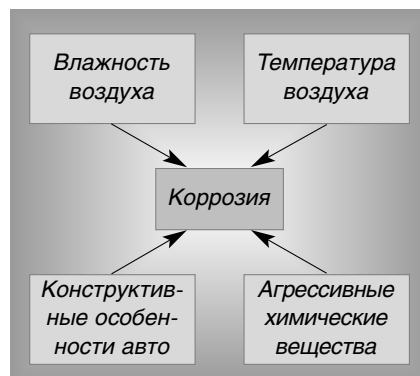
Основные факторы, вызывающие «болезни» металлических деталей автомобиля.
