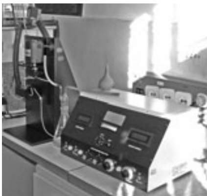
Прибор, имитирующий холодный пуск - CCS (Cold Cranking Simulator). Кстати, он установлен у одного из известных украинских производителей смазочных материалов.
