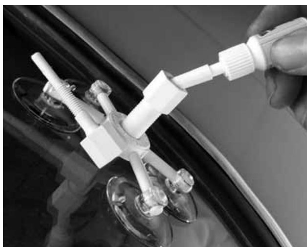
Мост закрепляется на стекле таким образом, чтобы инжектор находился точно над местом повреждения, с помощью инжектора в повреждение вводится полимер.
