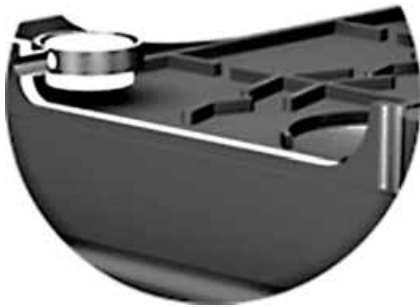
Крышка АКБ с лабиринтной системой улавливания газов. Аккумуляторы AGM не нуждаются в подобных хитроумных системах вентиляции, которыми приходится снабжать стандартные необслуживаемые аккумуляторы со сводным электролитом.
