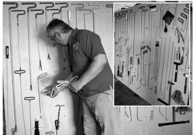
Комплект инструмента весьма обширный. Однако и это не предел. В планах - пополнить его еще несколькими позициями. Ведь главное - скорость работы и возможность добраться до вмятины даже в крайне сложных местах.
