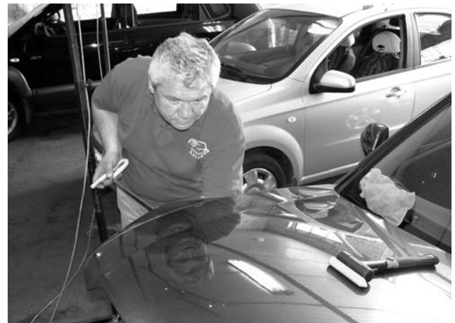
По мнению Виктора Рыбачука, самый эффективный способ удаления вмятин - при помощи рычагов. В процессе выравнивания нужно давить на дно вмятины, чтобы его размять. К тому же с помощью наставки и молоточка необходимо постепенно сглаживать/садить металл на ребрах (вершинах) по периметру вмятины. Таким образом она постепенно выводится и поверхность выравнивается.
