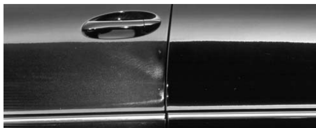
Покрытие CeramiClear после 1000 циклов мойки
