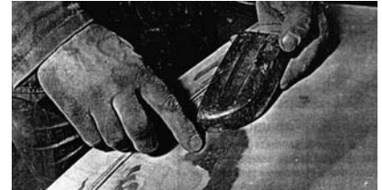
Рис. 18. Здесь был нанесен удар и на панели осталась вмятина, вдавленная в канавку поддержки. Если этого мало для устранения выпучивания панели, можно повторить удар, повернув поддержку на 90 градусов.
