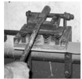
Устройство для нарезки из рулонов абразивной бумаги полосок нужного размера с отверстиями пылеотвода для шлифовальных блоков.
