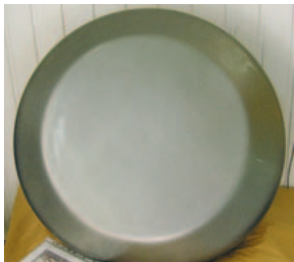
Фото 1. Перед нанесением рисунка деталь обязательно матируется и обезжиривается.
