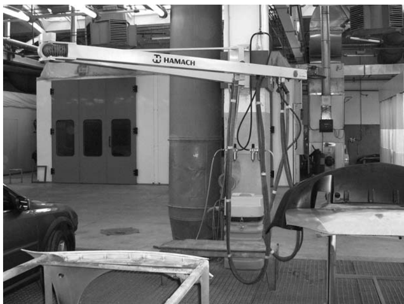
Терминал с вращающейся консолью (для подвода сжатого воздуха и электричества к пневмо- и электроинструменту) способствует повышению удобства и продуктивности выполняемых работ.
