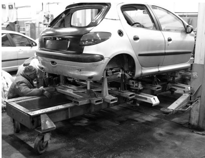
Мобильный рамный рихтовочный стенд. Главное его преимущество – возможность перемещения по ремонтной зоне. К тому же автомобиль можно закрепить прямо на подъемнике и перевести в более удобное для рихтовки место.
