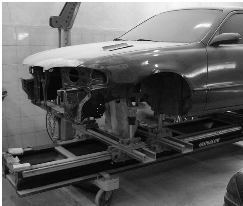
Мобильный рамный рихтовочный стенд. Главное его преимущество – возможность перемещения по ремонтной зоне. К тому же автомобиль можно закрепить прямо на подъемнике и перевести в более удобное для рихтовки место.
