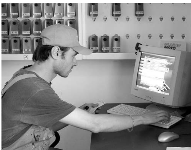
Приготовление цветов красок или их оттенков осуществляется на основе рецептов, поставляемых производителями ЛКМ. Подбор ремонтных цветов красок, соответствующих фактическим, производится специальными системами, включающими спецоборудование и программное обеспечение.
