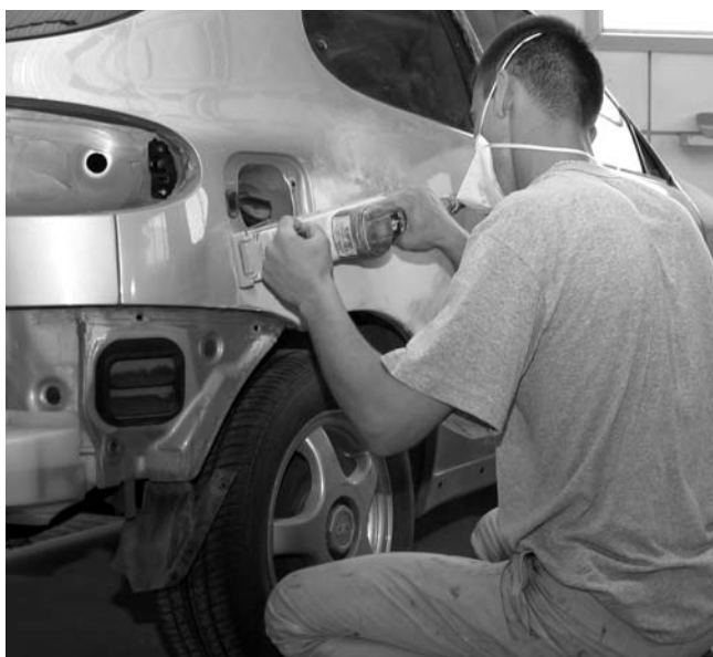
После шпатлевания поверхность выравнивается и наносится слой грунта.
