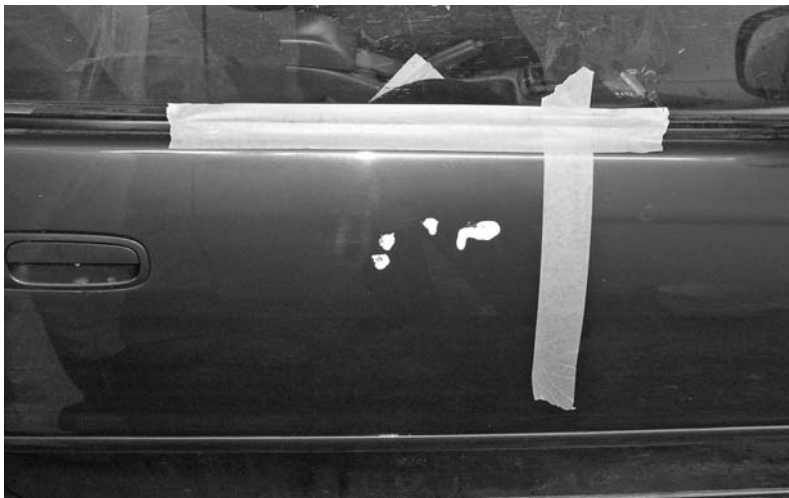
Фото 1. Подготовка к покраске
