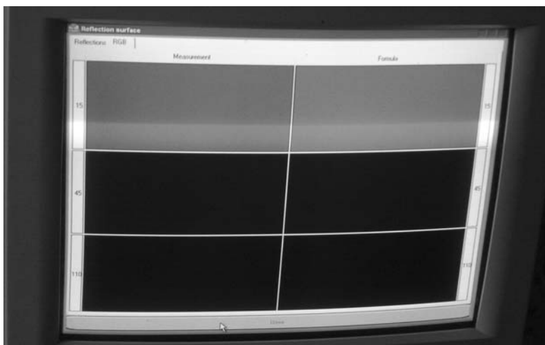
Фото 5. Компьютерный подбор краски на основании данных прибора GENIUS+
