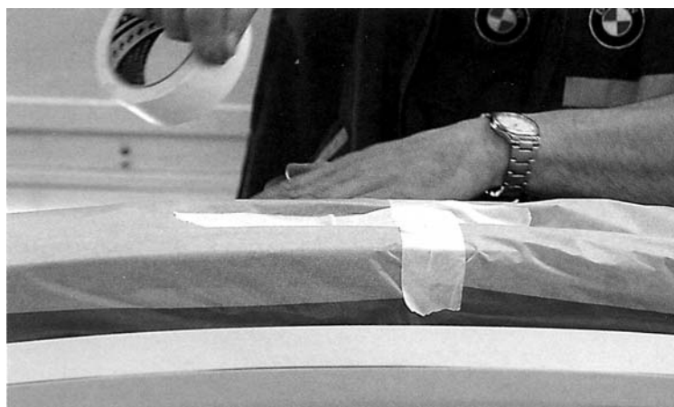
Процесс подготовки и окраски новой кузовной детали в нормальных условиях автосервиса занимает немногим более часа для одного элемента
