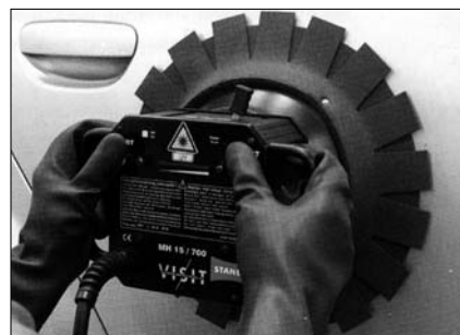
Порозаполнитель высыхает при облучении портативной УФ лампы. Требуются всего два цикла по десять вспышек.
