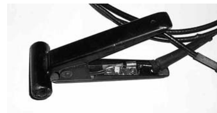
Более ранняя конструкция емкостного датчика фирмы BOSCH
