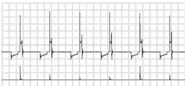
Осциллограмма вторичного напряжения системы зажигания (USB-Oscilloscope)
