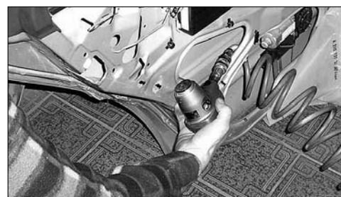
Пневматический правочный молоток для работы в труднодоступных местах
