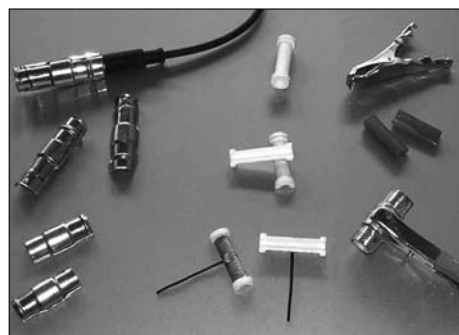
Конструкция емкостного датчика для USB-Oscilloscope
