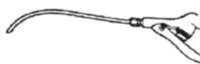
Рис.2. Подключение пистолета для подачи воздуха в магистрали гидравлической системы
