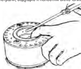
Рис.4. Точки подачи воздуха для проверки отдельно взятых собранных пакетов фрикционов
