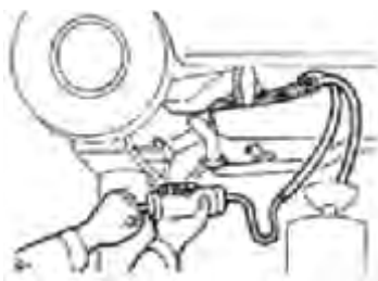
Рис. 5. Агрегат для промывки трубок и радиатора с использованием промывочной жидкости
