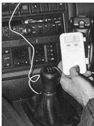
С помощью специального прибора можно определить температуру и интенсивность циркуляции воздуха в любой точке салона автомобиля.
