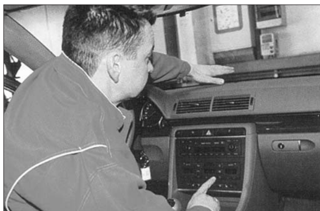
Для проверки работы системы кондиционирования в первую очередь ее нужно запустить для прогрева компрессора и определить температуру поступающего в салон автомобиля воздуха.
