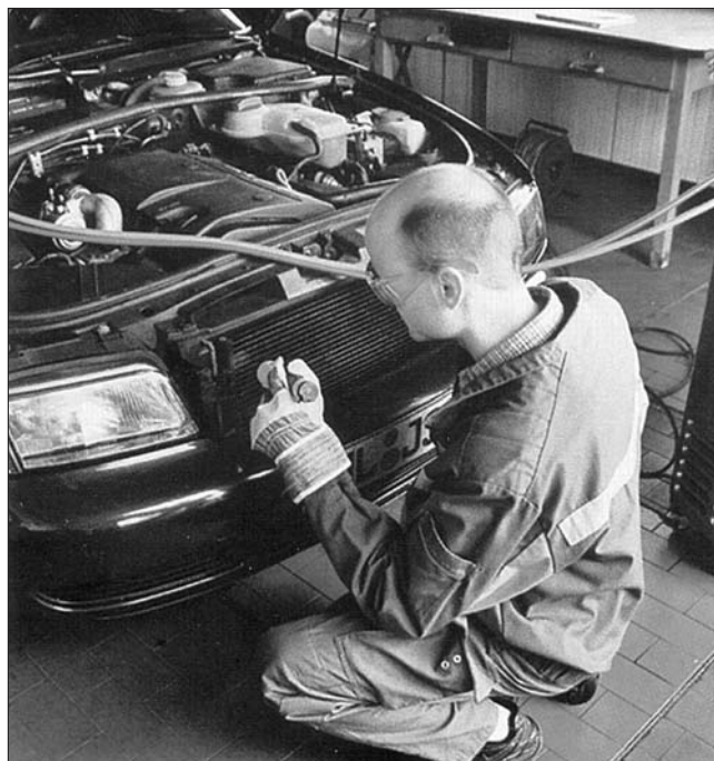
С помощью флюоресцентного красителя, добавленного в хладагент, ультрафиолетовой лампы и очков с УФ-фильтром можно выявить места утечки.
