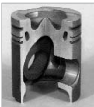
Поршень с упрочняющей вставкой для компрессионного кольца с каналом для охлаждения
