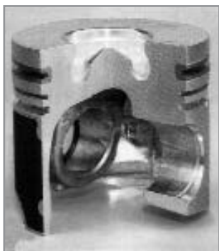
Литой поршень с неразрезной юбкой
