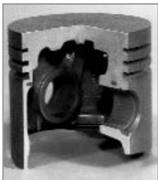
Поршень с терморегулирующей кольцевой вставкой
