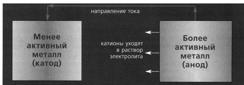
Так происходит разрушение металла в гальванической паре.
