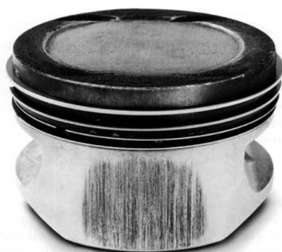
Задир на поршне, возникший из-за смывания масла топливом со стенок цилиндра.
