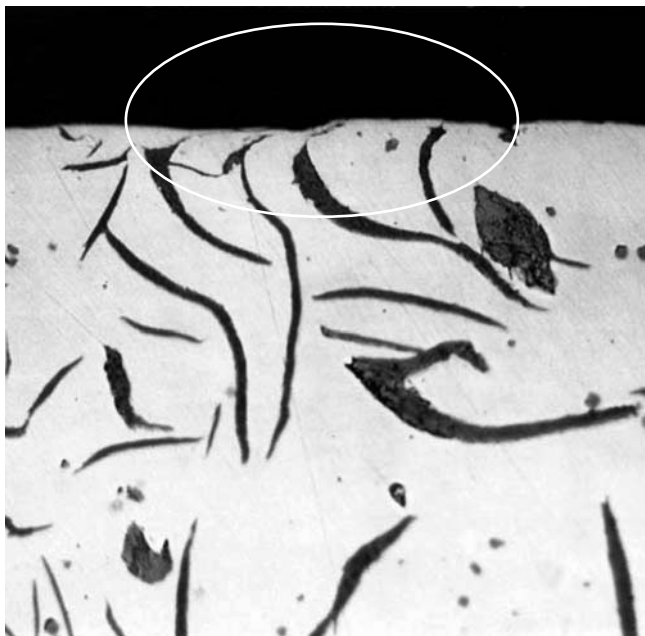
Рис. 2. Плато после тонкого хонингования. Зерна графита сжаты на поверхности
