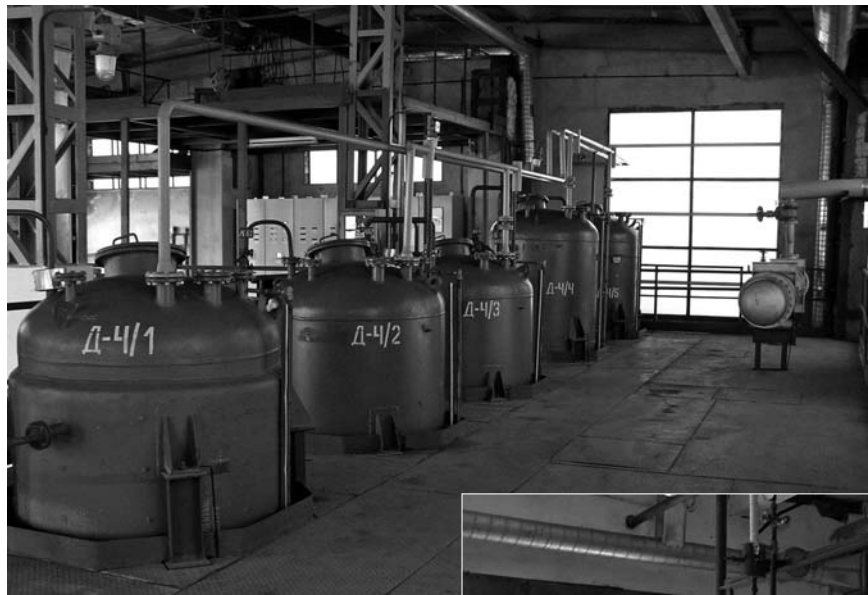
Расходные емкости, из которых необходимые для производства смазочных материалов компоненты дозировано подаются в реактор.
