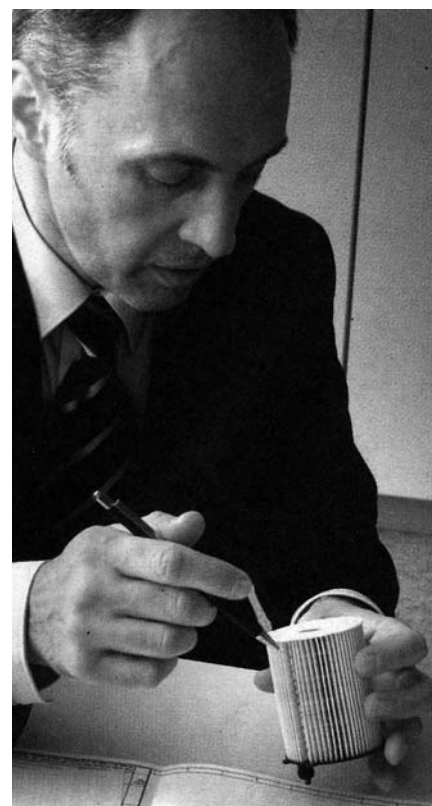
Волокно и бумажная звезда спаяны ультразвуковыми волнами без применения растворителей.
