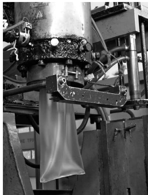
После изготовления "чулка" заготовка канистры подается в пресс-форму
