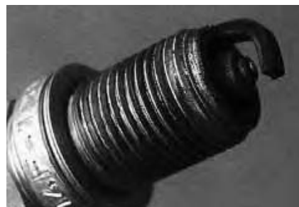
Центральный изолятор свечи покрыт густой сетью следов микропробоев - это пространственное следствие применения "бодяжного" бензина.
