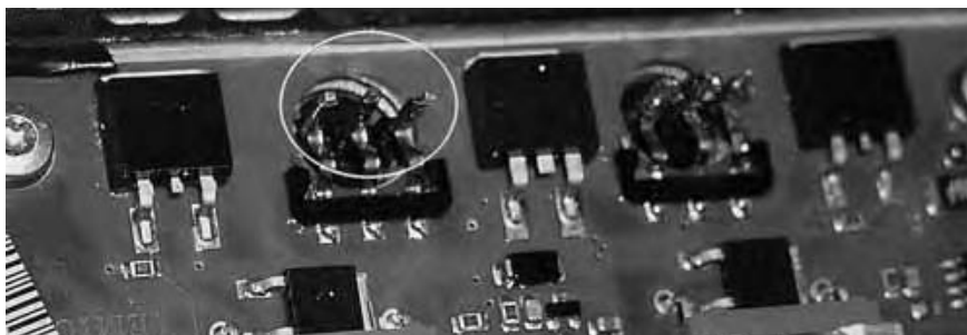
Выводы катушки соединены с тоководами платы методом контактной сварки. В то же время не видно препятствий к тому, чтобы при желании сделать узел катушки сменным.
