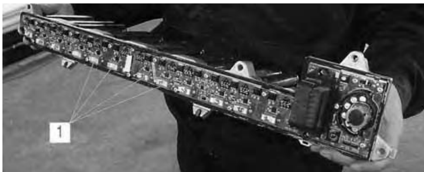
Удалив не подлежащую снятию крышку моноблока, можно увидеть много электротехнических компонентов, в том числе конденсаторы (1), используемые для первичного накопления энергии искры.
