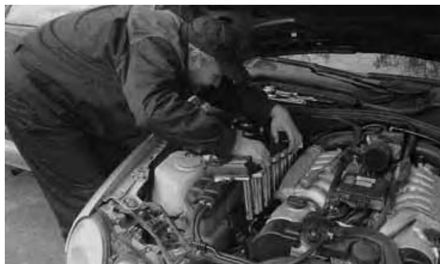
Системой самодиагностики зафиксированы пропуски воспламенения смеси в левой группе цилиндров. Демонтируем соответствующий оноблок индивидуальных катушек.
