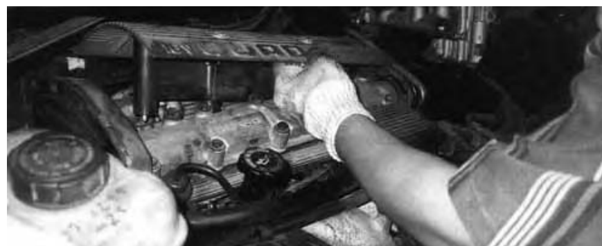
Моноблочные системы применялись на 4-цилиндровых двигателях GM. Для доступа ко вторичным цепям системы рекомендуется снять моноблок и соединить его со свечами проставочными проводами.
