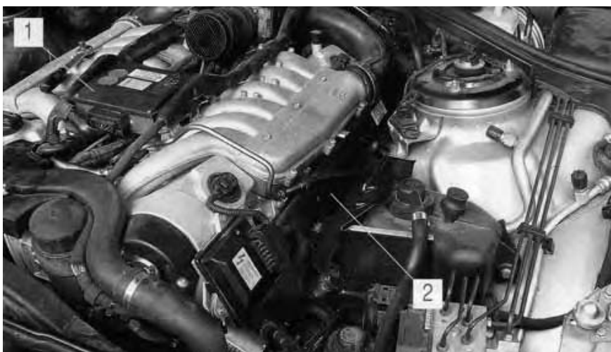
Система зажигания двигателя имеет собственный интеллектуальный модуль (1), который управляет двумя моноблоками (2). Каждый из моноблоков объединяет индивидуальные катушки (по две на один цилиндр) одной из "банок" двигателя.
