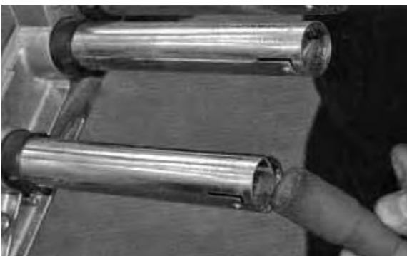
Причину неисправности удастся обнаружить визуально. Поверхности одного из полимерных наконечников обуглены.
