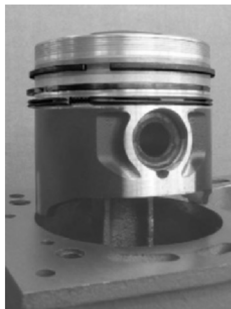
Поврежденные поршневые кольца влечут за собой перемешивание масла и топлива
