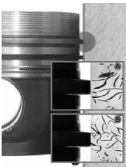
Процент вскрытия зерен графита в 20% важен для образования смазочной пленки и сохранения ее служебных свойств
