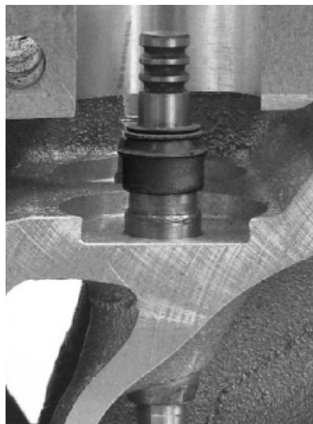
Слишком высокое давление масла оказывает нагрузку на уплотнение стержня клапанов
