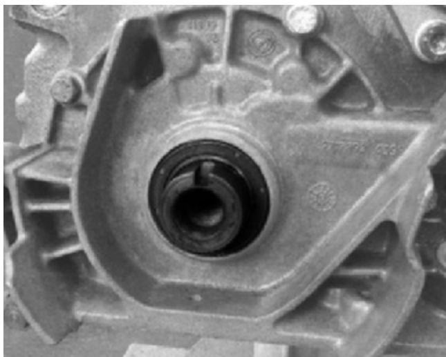
Утечки на радиальных уплотнительных кольцах вала появляются также из-за слишком высокого давления масла
