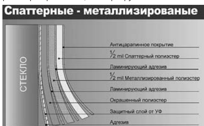
Конструкция одного из видов тонирующих пленок
