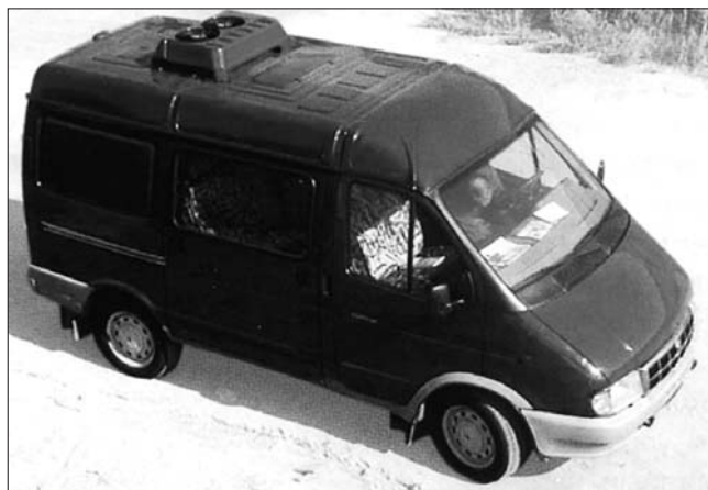
Наиболее популярный вариант кондиционера для семиместных "ГАЗелей" и микроавтобусов - крышный разнесенный кондиционер. Состоит из крышного блока - конденсора, внутреннего блока - испарителя, компрессора и фреонопроводов. Холодопроизводительность кондиционера 9 кВт. Воздушный поток 800 м³/ч; потребляемый ток 24 А.
