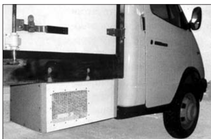
Блок электропривода, расположенный под изотермическим фургоном а/м "ГАЗель"
