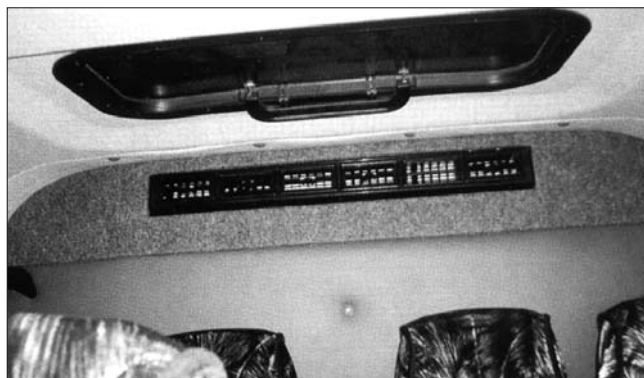
Наиболее популярный вариант кондиционера для семиместных "ГАЗелей" и микроавтобусов - крышный разнесенный кондиционер. Состоит из крышного блока - конденсора, внутреннего блока - испарителя, компрессора и фреонопроводов. Холодопроизводительность кондиционера 9 кВт. Воздушный поток 800 м³/ч; потребляемый ток 24 А.
