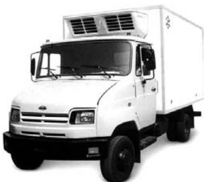
Рефрижераторная установка "Серия-4"-на автомобиле ЗИЛ "Бычок"
