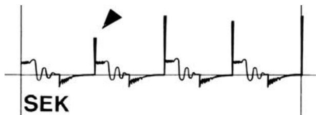
Рис. 4. Осциллограмма напряжения во вторичной цепи.
