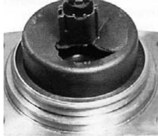
Рис. 4. Крышка АБС разрушена из-за неправильного обращения или некорректной установки.
