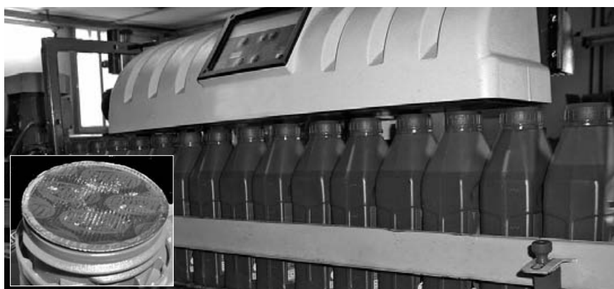
Еще один элемент защиты - запайка специальными металлическими мембранами с логотипом.
