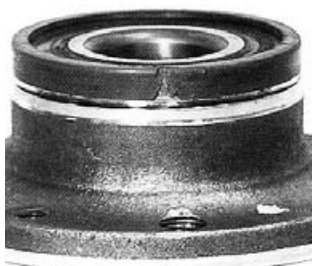
Рис. 3. Сенсорное кольцо АБС разрушено в результате внешних воздействий во время движения.
