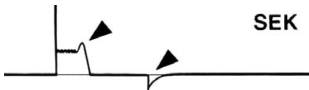
Рис. 11. Напряжение во вторичной цепи системы зажигания.
