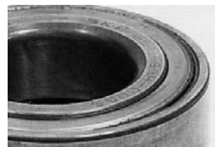
Рис. 10. Уплотнение смещено из-за неправильной установки при монтаже в ступицу.
