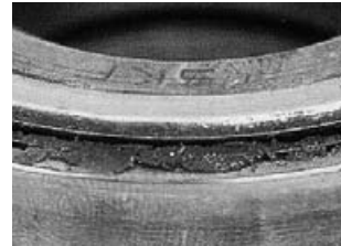
Рис. 12. При увеличении видны следы утечки смазки.
