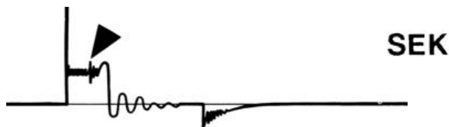
Рис. 8. Напряжение во вторичной цепи системы зажигания.
