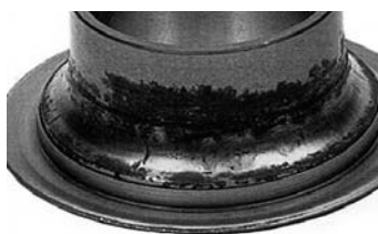
Коррозия - результат проникновения воды.
