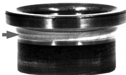
Широкий след траектории по всему диаметру дорожки качения.
