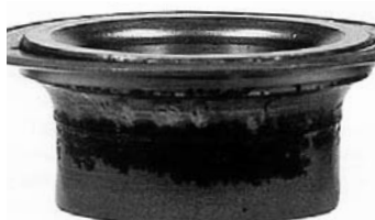
Повреждение формы маслосъемных колец на внутреннем кольце подшипника.
