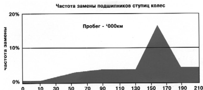
Диаграмма частоты замены подшипников ступиц колес
