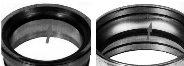
Признак поворота внутреннего кольца относительно оси из-за слабой посадки.
