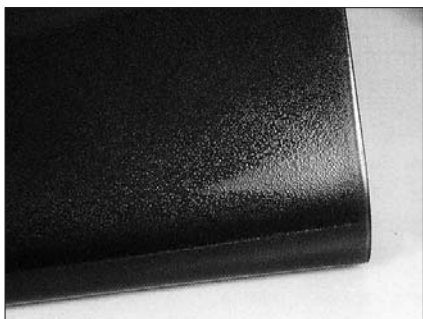
Раковины - так как лакокрасочный материал был нанесен слишком рано.
