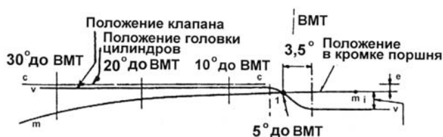
Рис. 6. Схема взаимодействия между поршнем и клапанами. 1 - точка начала взаимодействия.
