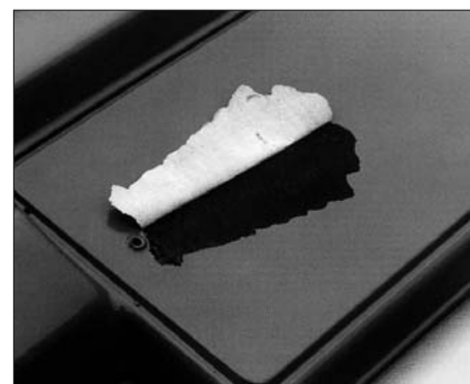
Нарушение адгезии из-за недостаточной очистки или использования неподходящих средств.
