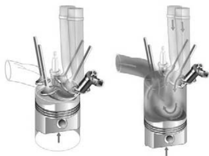
Рис. 1. Схема работы полнотактного мотора в двухтактном режиме.
