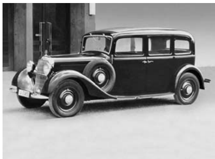
Первый в мире дизельный легковой автомобиль с системой впрыска Bosch - модель Mercedes-Benz 260D (1937 год).
