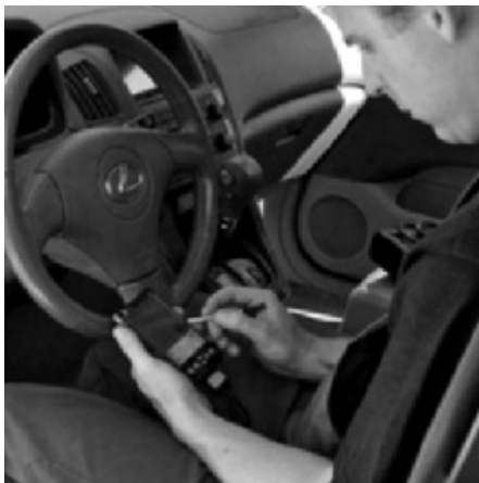
Фото 9. Проверка Lexus RX 300 с помощью сканера CJ-II.
