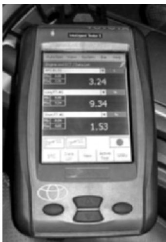
Фото 1. OEM сканер Toyota/Lexus (Denso).
