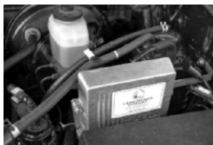
В четвертом поколении за подачу газа отвечает свой собственный ЗВУ.
