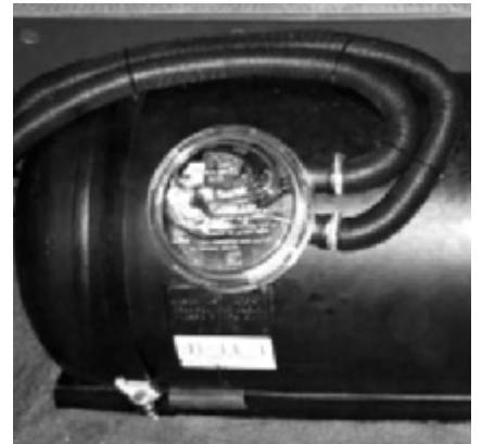
Вентиляционная коробка - один из элементов системы безопасности ГБО.
