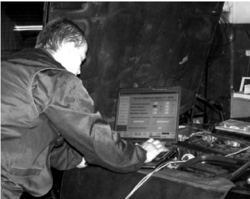
Обычно для настройки работы ГБО используют ноутбук с необходимым программным обеспечением.
