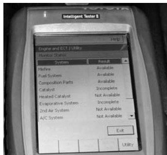
Фото 3. Информация о результатах выполнения тестов (флаги мониторов) различных систем на экране современного сканера.
