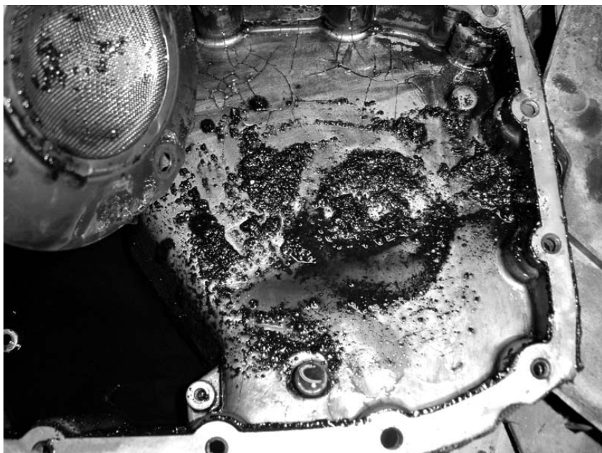
При работе в масле неизбежно накапливаются механические примеси (пыль, песок, продукты износа двигателя и т.д.)
