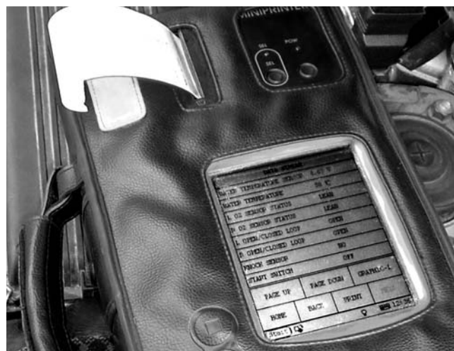
Фото 2. Фрагмент режима индикации параметров инжекторной системы прошлых лет. Немного, но тоже может быть полезным.
