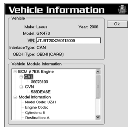
Рис. 6. Идентификационные параметры современного автомобиля, считываемые из памяти БУ диагностическим сканером.
