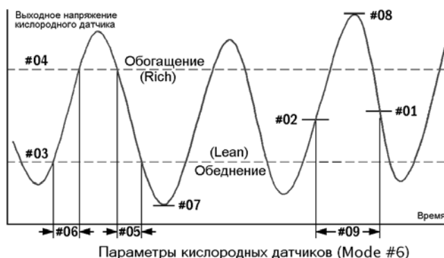
Рис. 2. Критерии оценки состояния кислородного датчика.
