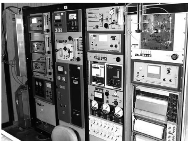
Фото 4. Стенд для проведения полного набора обязательных проверок при проведении теста "Inspection and Maintenance Test" (I/M Test), немного похожего на наш техосмотр.
