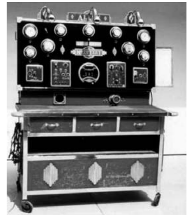
Фото 2. Один из первых специализированных автомобильных тестеров ("tune-up" machine) ALLEN.
