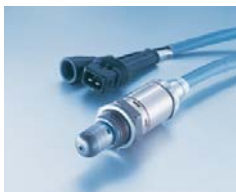
Подогреваемый 3-проводный лямбда-зонд. Интервал замены - каждые 100 000 - 160 000 км.
