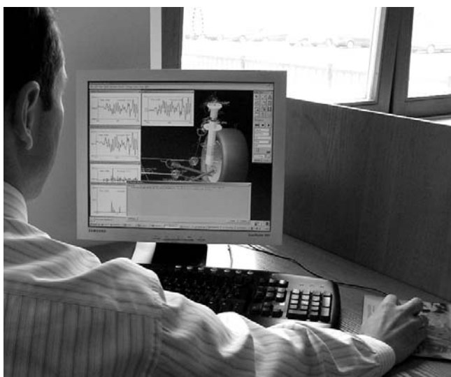
Моделирование со многими элементами: подвеска в движении и рабочие параметры амортизатора.
