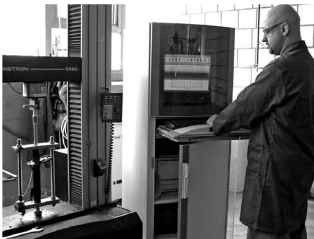
Исследование буфера отбоя (прогиб под действием нагрузки). Испытания на долговечность проводятся в условиях реальной работы амортизатора. По данным испытаний, при нагрузке 500 Н отклонение - 1 мм.
