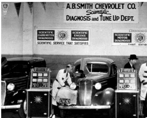
Фото 1. Рабочее место СТО 30-х годов. Нельзя не обратить внимания читателей на то, что уже в те годы было принято в рабочей зоне застилать крылья автомобиля специальной накидкой.
