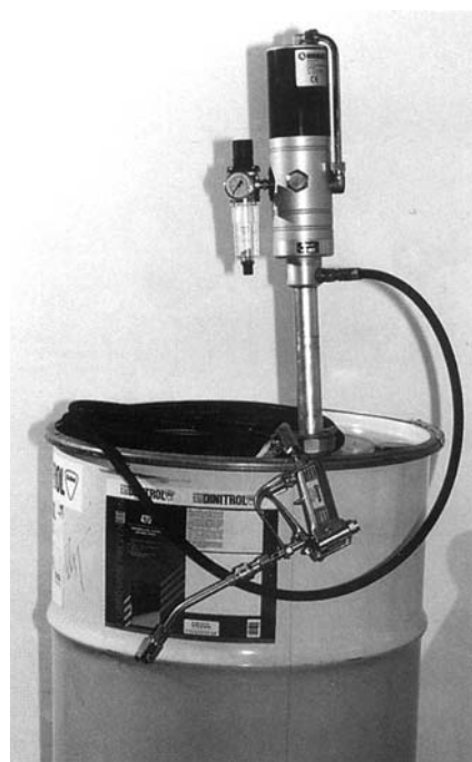
Насос, подсоединенный к бочке с материалом.
