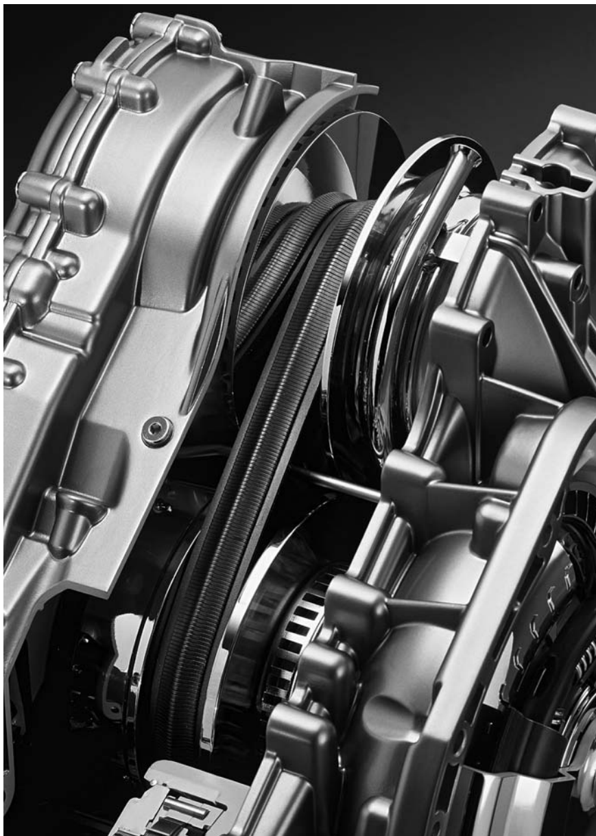
Вариатор VDT в разрезе.
