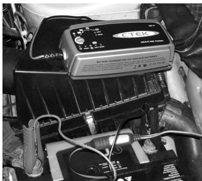
Фото 4. Подключение MULTY XS7000 к автомобилю.
