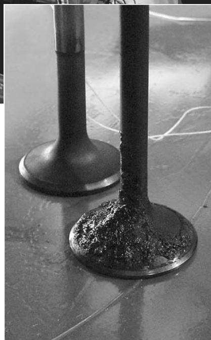
Два клапана (один - чистый, второй - с нагаром) Андреас Шафер обмакнул в топливо и поджег. Пламя на клапане с отложением наблюдалось дольше. То же самое происходит и в двигателе автомобиля.
