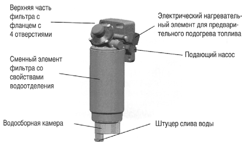
Рис. 7. Предварительный фильтр дизельного топлива для грузовых автомобилей в сменном исполнении, со встроенным водоотделителем и электроподогревом топлива.
