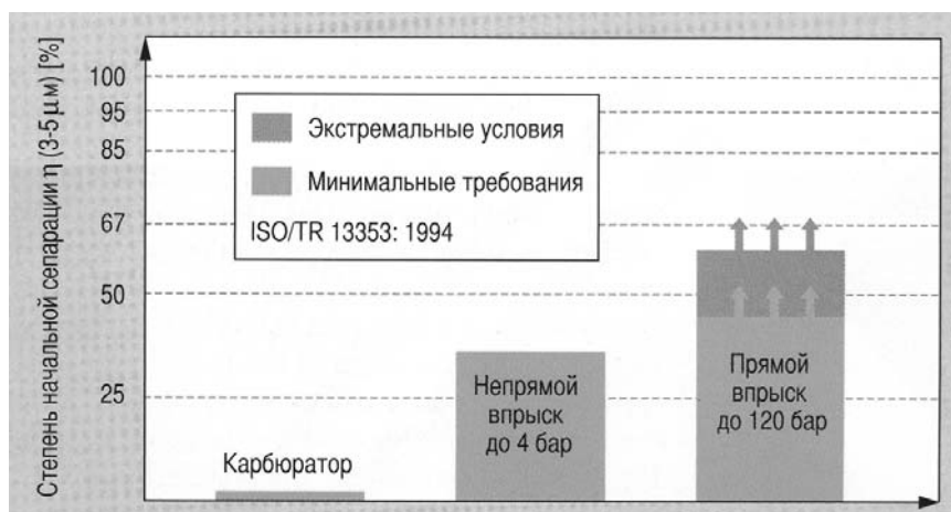
Рис. 2. Рекомендации по минимальной тонкости очистки для бензиновых топливных фильтров.
