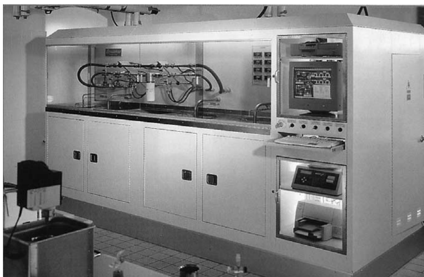
Фото 3. Многопроходный испытательный стенд для измерения сепарации частиц в реальном времени по стандарту ISO 4548-12
