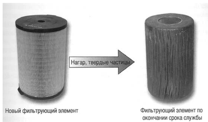
Рис. 15. Новый элемент тонкой очистки и тот же элемент по истечении срока службы
