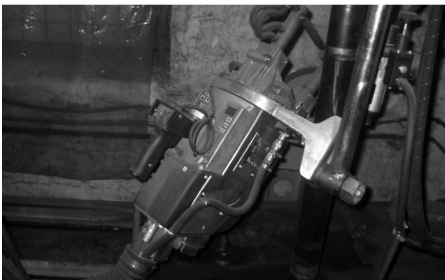
Аппарат контактной сварки с охлаждением и пневмоприжимом. С его помощью на карданный вал привариваются балансировочные грузки.
