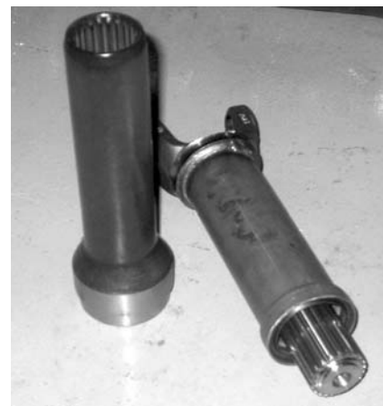
Рилсановое покрытие на втулке.
