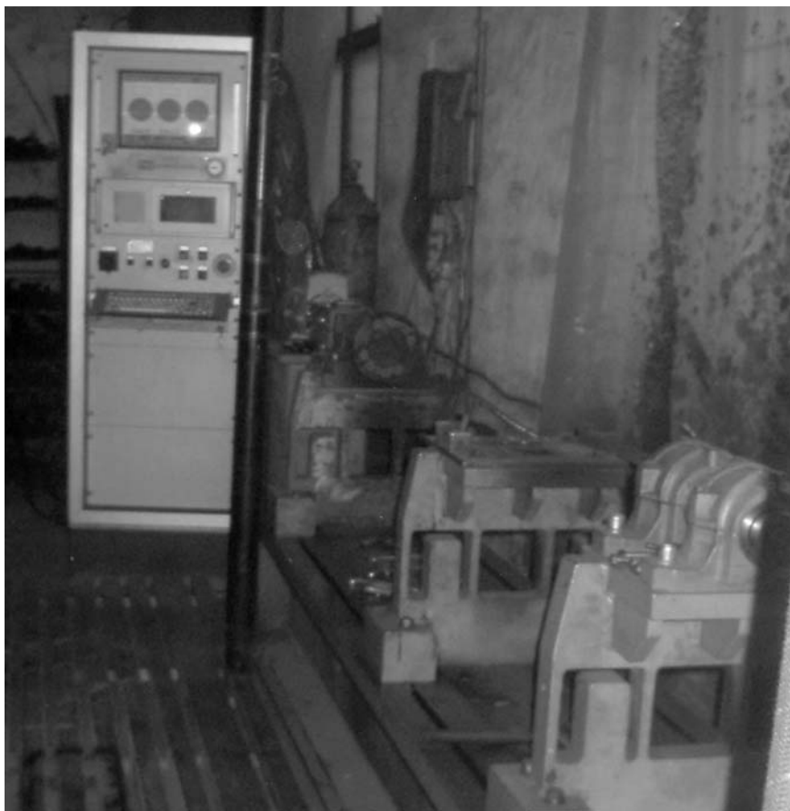
Стенд для балансировки карданных валов. В Украине такой стенд существует в единственном экземпляре.
