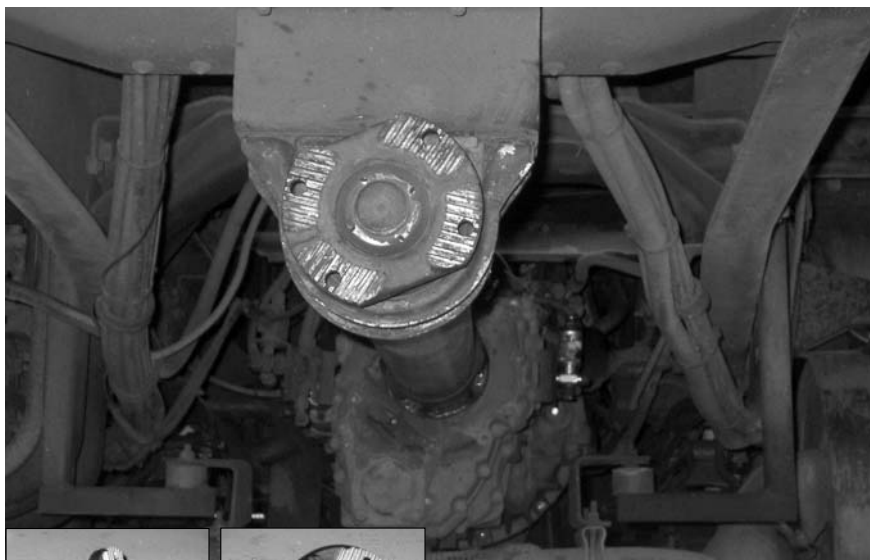
Фланцы с торцевыми шлицами обеспечивают самое надежное крепление. На фланцах нет ни одного лишнего грамма металла.
