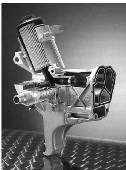
Фото 2. Модуль масляного фильтра для четырехцилиндрового дизельного двигателя с неметаллическим фильтрующим элементом и интегрированными дополнительными устройствами (охладитель масла, p- и T-сенсоры, подогрев масла, клапаны, держатель для генератора)
