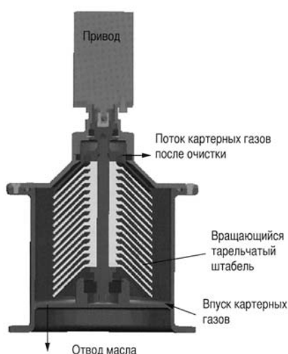
Рис. 5. Конструкция сепаратора тарельчатого типа для отделения аэрозолей масляного тумана из системы вентиляции картера
