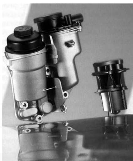
Рис. 4. Модуль масляного фильтра с встроенным двойным циклоном для отделения капель масла из газов картера
