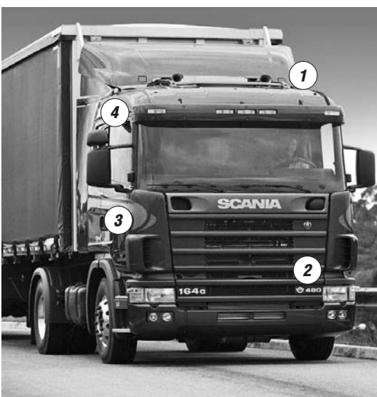
Фото 4. Расположение места забора воздуха серьезно влияет на объем поступающей пыли и воды.
