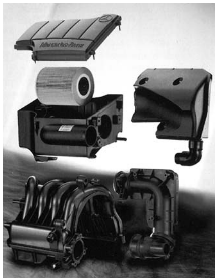
Фото 1. Система подачи воздуха (модульная структура) в целом, включая корпус фильтра, датчик массы воздуха, независимый резонатор и впускную трубу двигателя.
