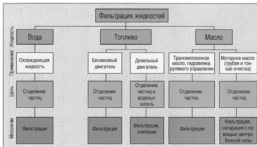
Рис.3. Цели и механизмы действия фильтрации жидкостей в автомобилях.
