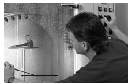
Имитационная камера, в которой продукты BERU проверяются на непроницаемость влаги, струй воды и солевого тумана.
