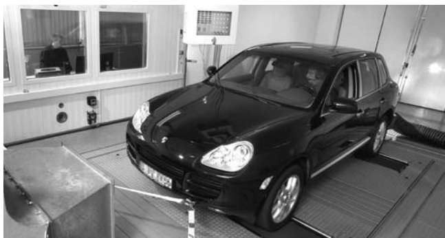
На новом холодильном полноприводном обкаточном стенде проверяются свечи зажигания и свечи накала, системы дизельного мгновенного старта и контроля давления шин, а также компоненты сенсорики и электроники.
