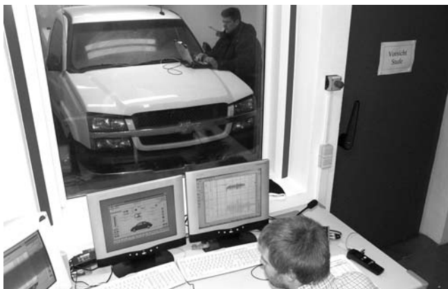
Эффективными тестами в морозильной камере техники BERU проверяют свои разработки в экстремальных условиях (до -30 °C).
