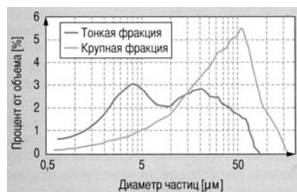
Рис. 13. Распределение размеров частиц крупной и мелкой пыли. Доля частиц диаметром от 5 мкм составляет всего 1% в крупной пыли, и 3% - в мелкой пыли. Частицы диаметром от 50 мкм встречаются в крупной пыли в объеме 5%, а в мелкой - 2%.
