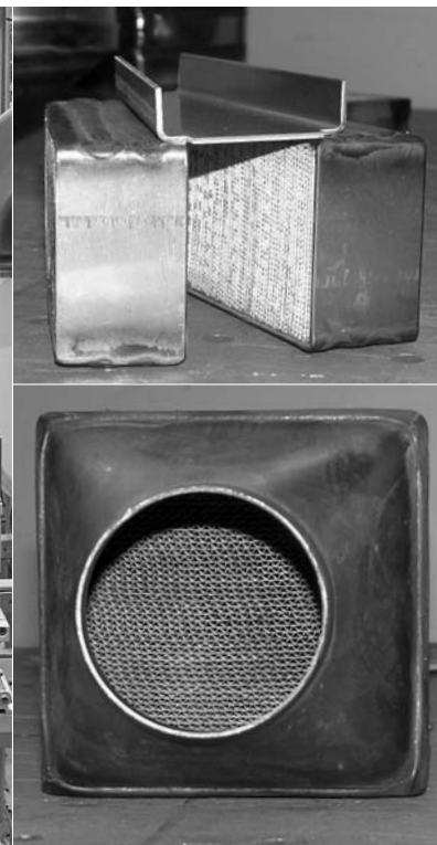
Лента фольги ("волнообразной" структуры) со специальным напылением режется на полоски. В дальнейшем из них формируют блоки - рабочие элементы каталитического конвертора.
