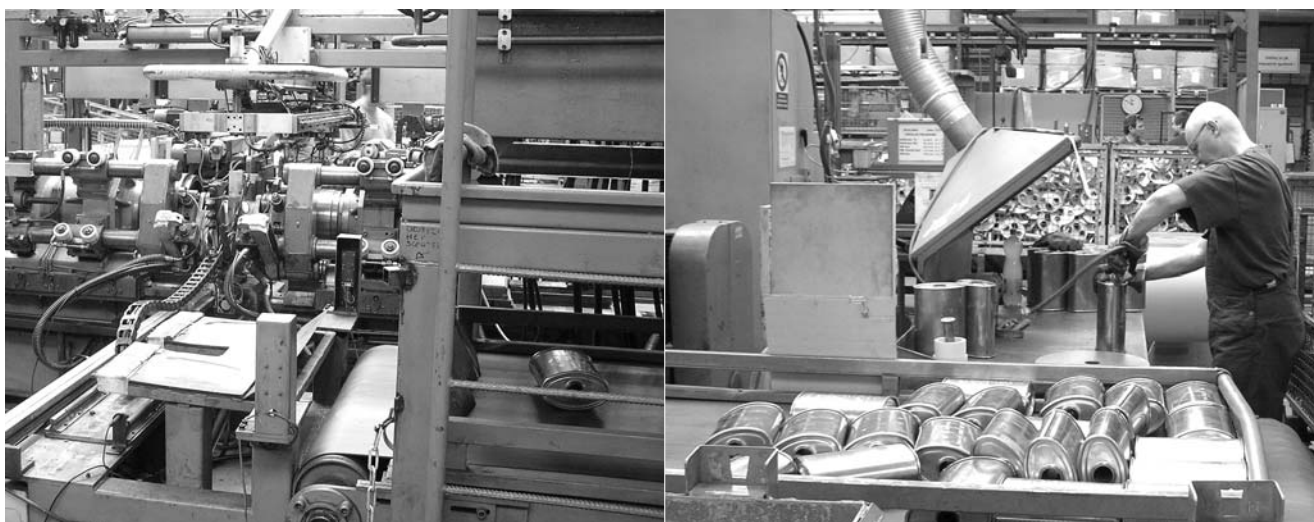
Установка, на которой проходит вальцевание. После обработки деталь (глушитель, резонатор) по конвейерной ленте поступает к рабочему на осмотр.
