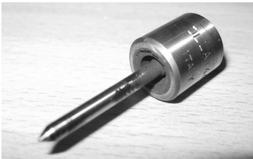
Распылитель с отколовшимся носиком. Носик (диаметр 7 мм и длина 28 мм) упал в цилиндр двигателя. Последствия можете представить сами.
