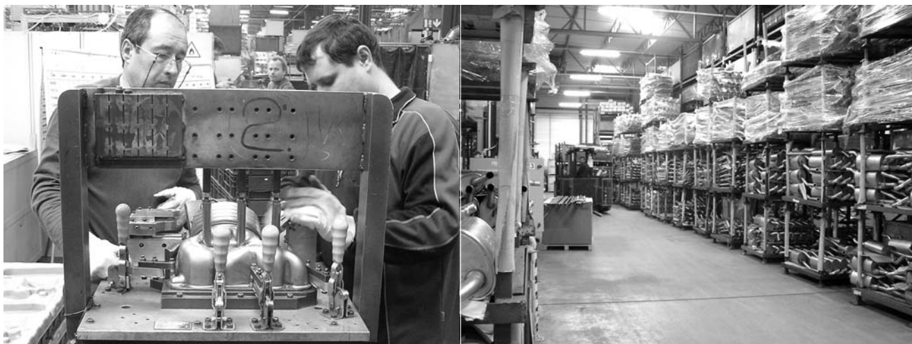
Готовая продукция (в данном случае - коллектор в едином блоке с катализатором) проверяется на предмет точности изготовления.
