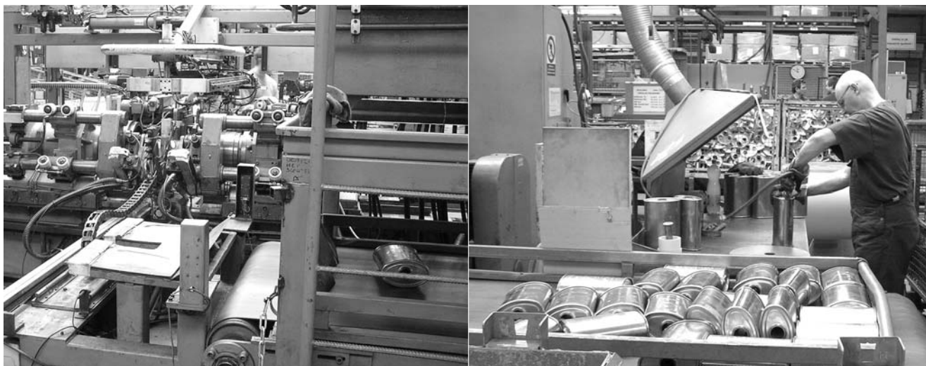
Установка, на которой проходит вальцевание. После обработки деталь (глушитель, резонатор) по конвейерной ленте поступает к рабочему на осмотр.
