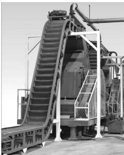
Производственная линия утилизации шин методом механического измельчения.
