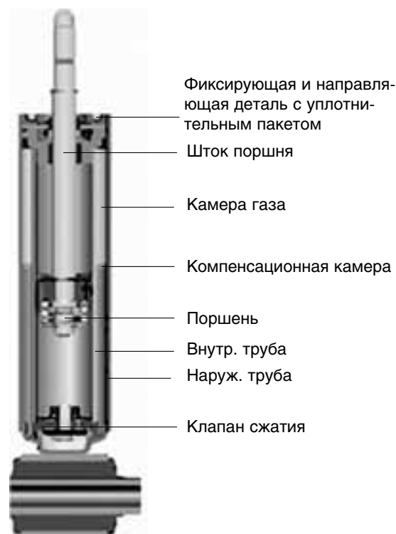
Конструкция двухтрубного газового амортизатора
