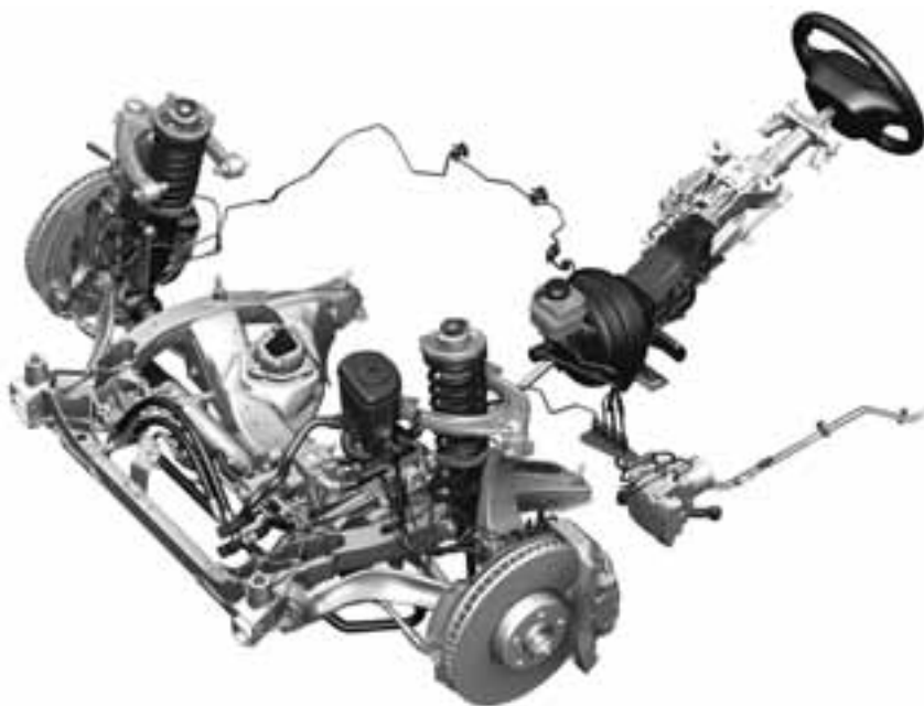
В очередном поколении 7-й серии BMW отошел от применявшейся ранее схемы McPherson и стал «как все» – с двухрычажной передней подвеской и мощным подрамником, что общепринято в этом классе автомобилей.
