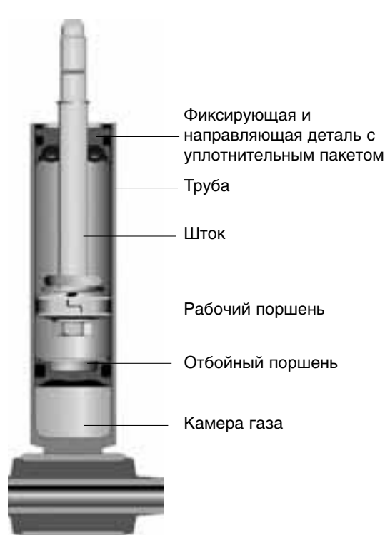
Конструкция однотрубного амортизатора
