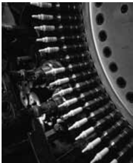
Корпус керамического изолятора проходит стадию маркировки.
