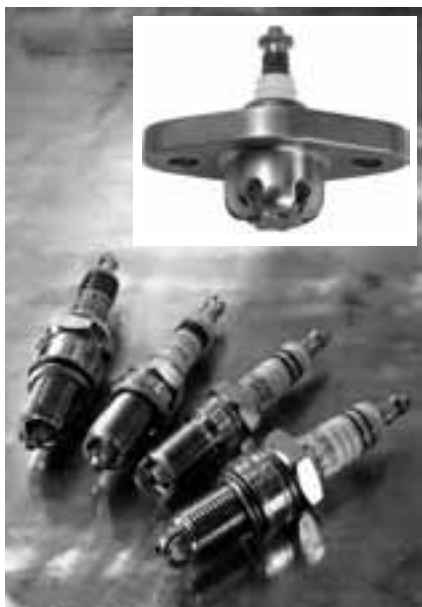
За 100 лет внешний вид свечей весьма изменился, в отличие от принципа действия (снизу – современные свечи, сверху – экземпляр начала века).
