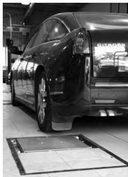
Платформа бокового увода определяет соответствие установки углов схождения колес в режиме «экспресс»-контроля.
