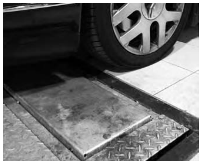
Платформа испытания подвески производит измерения по методу EUSAMA (Европейского сообщества производителей амортизаторов).
