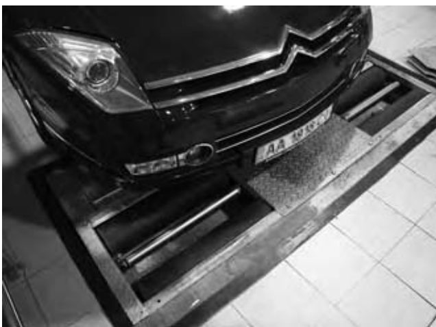
Тормозной стенд в виде двух основных и одного вспомогательного роликов позволяет выполнить измерения нескольких параметров: сопротивление свободному качению, биение тормозного барабана или диска, эффективность работы тормозных систем каждого колеса.
