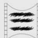
Бриннелирование дорожек качения. Регулярные выемки на дорожках качения.
