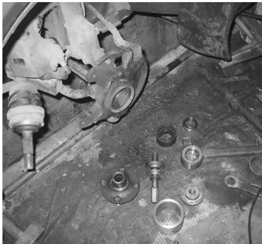
При монтаже подшипников необходимо соблюдать чистоту (закрывать детали автомобиля, куда будет устанавливаться подшипник, и еще не установленный подшипник пластиковой пленкой, парафинированной бумагой или чистой сухой безворсовой тканью).
