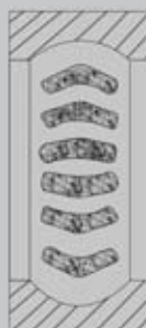
Псевдобриннелирование. Выемки на дорожках качения за счет сдвига металла.
