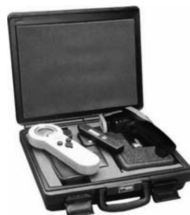
Диагностировать состояние подшипников и степень их износа по уровню шума позволяют специальные приборы.
