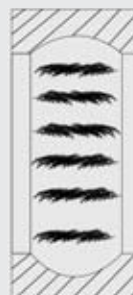
Бриннелирование дорожек качения. Регулярные выемки на дорожках качения.
