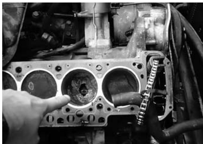
Прогар поршней — закономерный итог неграмотного тюнинга.
