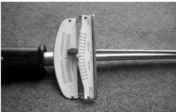
Стрелочный динамометрический ключ — самый дешевый среди своих «собратей», однако имеет наибольшую погрешность.
