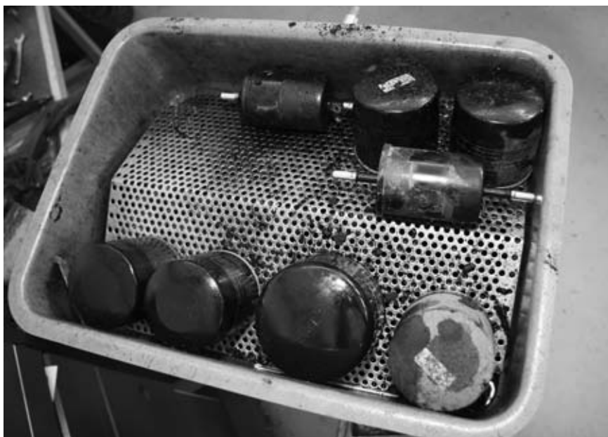
По наличию или отсутствию частиц металла в снятом масляном фильтре можно понять, в каком состоянии пребывают трущиеся детали двигателя.
