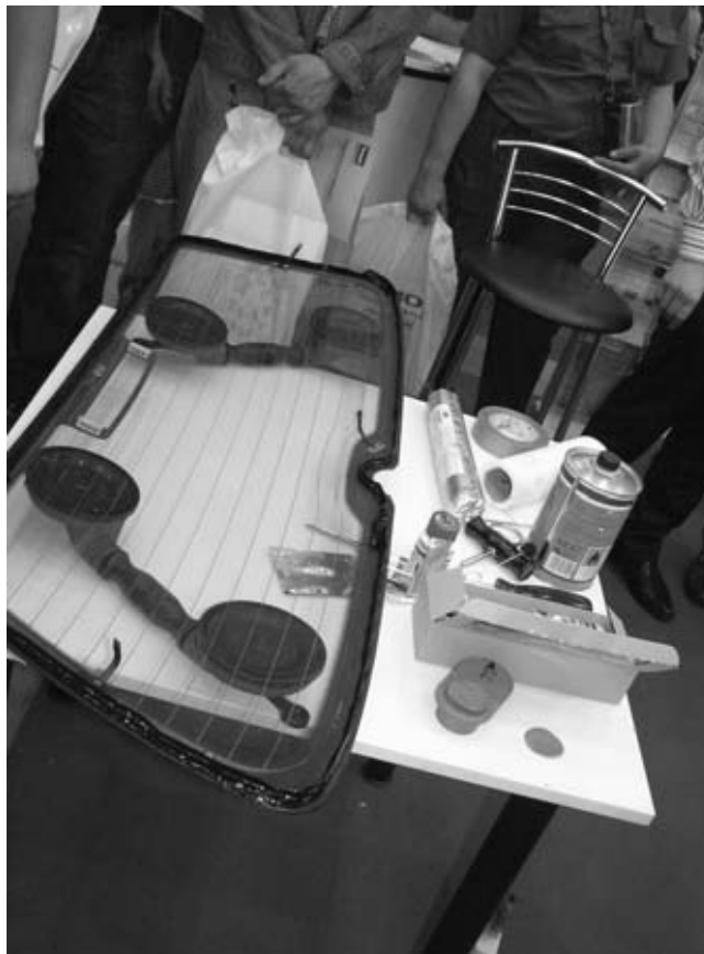
В верхней части стекла не должно быть никаких стыков; перекрытие шва следует делать только в нижней его части.
