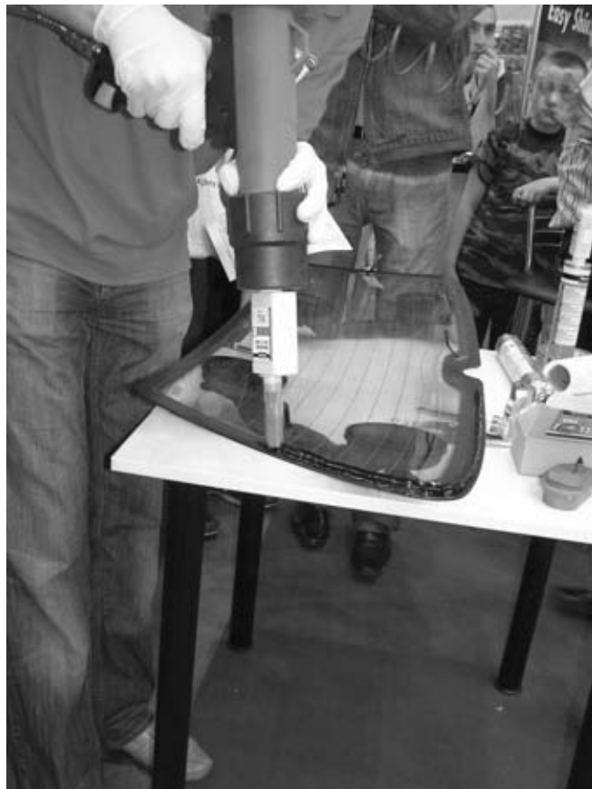
Начинать шов нужно только в нижней части стекла и держа пистолет вертикально.
