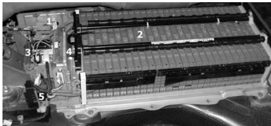
Фото 2. ВВ-батарея и расположение части элементов ее управления.
